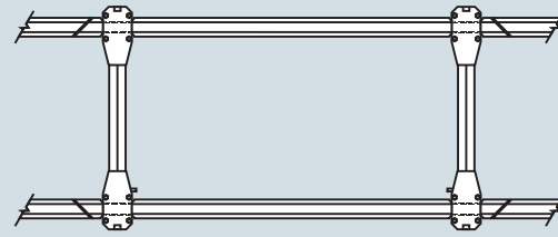
Rieles y barras transversales hacia la parte superior de las células de carga (vista superior sin la estructura principal de la báscula de pesaje)
