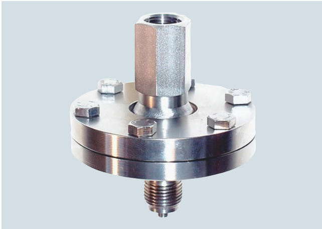
Sellos de membrana separadora, tipo roscado, con membrana interior, para presión relativa, absoluta y diferencial, para montaje directo
